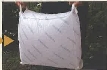
約2分後に約20kgの土嚢が完成
